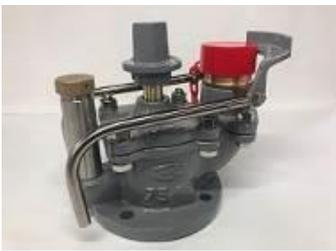
浅埋型消火栓に簡易空気弁「排気弁」を付け、管路に設置する空気弁の補助的役割を消火栓に持たせました。
