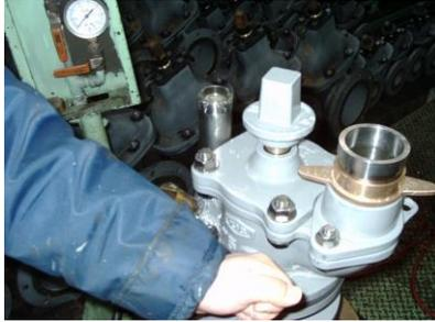
9. フロート、弁座押えの順番に取り付けて下さい。弁座押えは斜めにならないように確実に押し込んでください。
