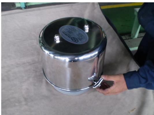
製品側面にある「作動チェック弁」を外します。
