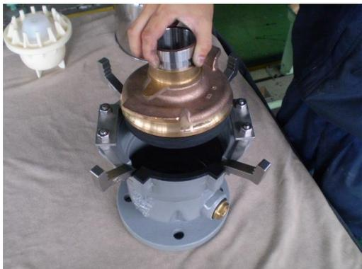
「マルチリング町野口金」を挿入します。
