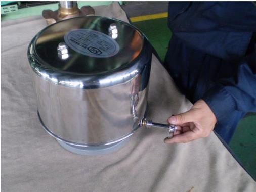
「作動チェック弁」を取り付けて下さい。
